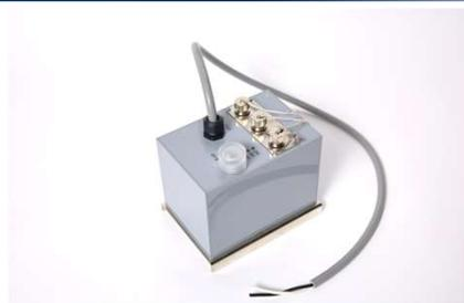
Leicouplerから得た電力を貯めておき、負荷の大きな機器に直流電圧を供給するものです。
